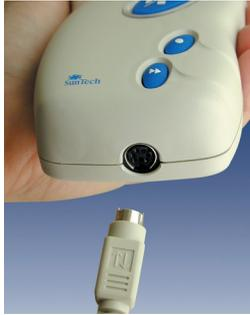
1. Connectez le câble d'interface PC à la connexion en bas du moniteur de PAA (Fig. 1).
