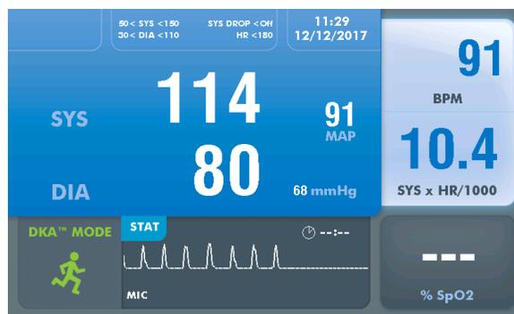
A configuração padrão do modo CONTÍNUO consiste em medir a PA com leituras sistólicas e diastólicas a cada dez segundos após o final da medição anterior. O monitor pode ser programado para realizar apenas medidas sistólicas a cada dois segundos selecionando-se a opção [Main Menu > Measurement Setup > Stat Mode Key \(Menu principal > Configurar medições > Tecla do modo Contínuo\)](#).
