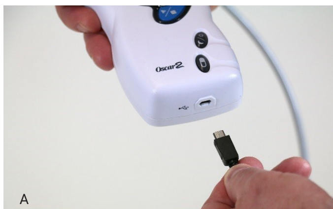
Figure 1: Připojení monitoru Oscar 2 k počítači
