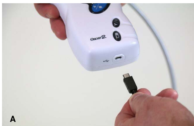
Figure 1: Podłączanie monitora Oscar 2 do PC
