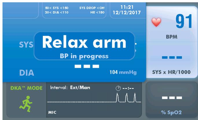
Quando o teste de esforço começar, o equipamento de teste de esforço acionará o monitor para que a pressão arterial seja aferida. O manguito inflará automaticamente para cada mensuração. A mensagem "RELAX ARM BP in progress" (RELAXE O BRAÇO PA sendo medida) será exibida até o final de medição. Em seguida, o resultado será mostrado. Se desejar, pressione o botão INICIAR/PARAR para iniciar ou interromper uma aferição de pressão arterial manualmente.
