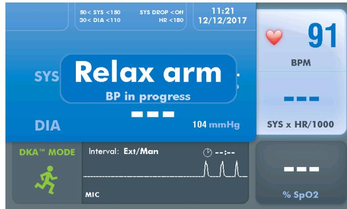
Nach dem Start des Belastungstests fordert das Ergometrie-System Blutdruckmessungen vom Monitor an. Für jede Messung wird die Manschette automatisch aufgepumpt. Die Meldung "Arm entspannen, BD wird gemessen" wird während der Messung angezeigt. Danach erscheinen die Messwerte. Manuelle Blutdruckmessungen können auch mit der Taste START/STOPP am Monitor ausgelöst werden. Mit der gleichen Taste können Sie eine Messung auch abbrechen.
