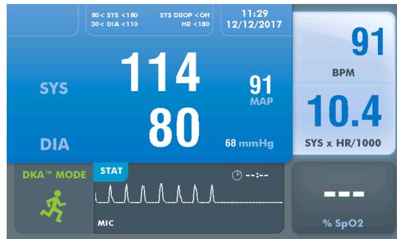
In der Standardeinstellung werden im STAT-Modus der systolische und der diastolische BD-Wert in Abständen von 10 Sekunden ermittelt. Über Hauptmenü > Messeinstellungen > Stat Mode-Schlüssel können Sie den Monitor so einstellen, dass alle 2 Sekunden nur der systolische Druck gemessen wird.
