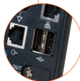
Ports USB en façade et sur le côté pour le lecteur de code-barres et Wi-Fi
